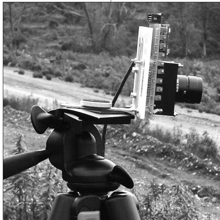
El sistema se basa en una cámara inteligente inalámbrica instalada sobre un soporte y conectada a un pequeño panel solar.
