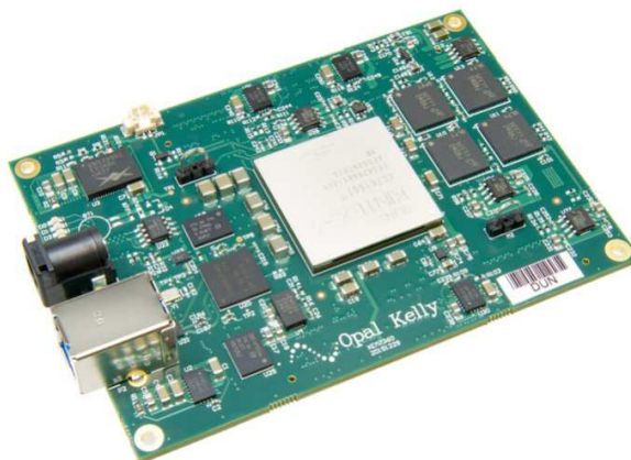
Figura 2.5. FPGA XEM7360 de Opal Kelly.
